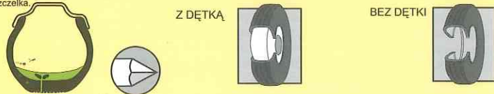
Zakleja dziury spowodowane przez przedmioty o średnicy do 10 mm.
